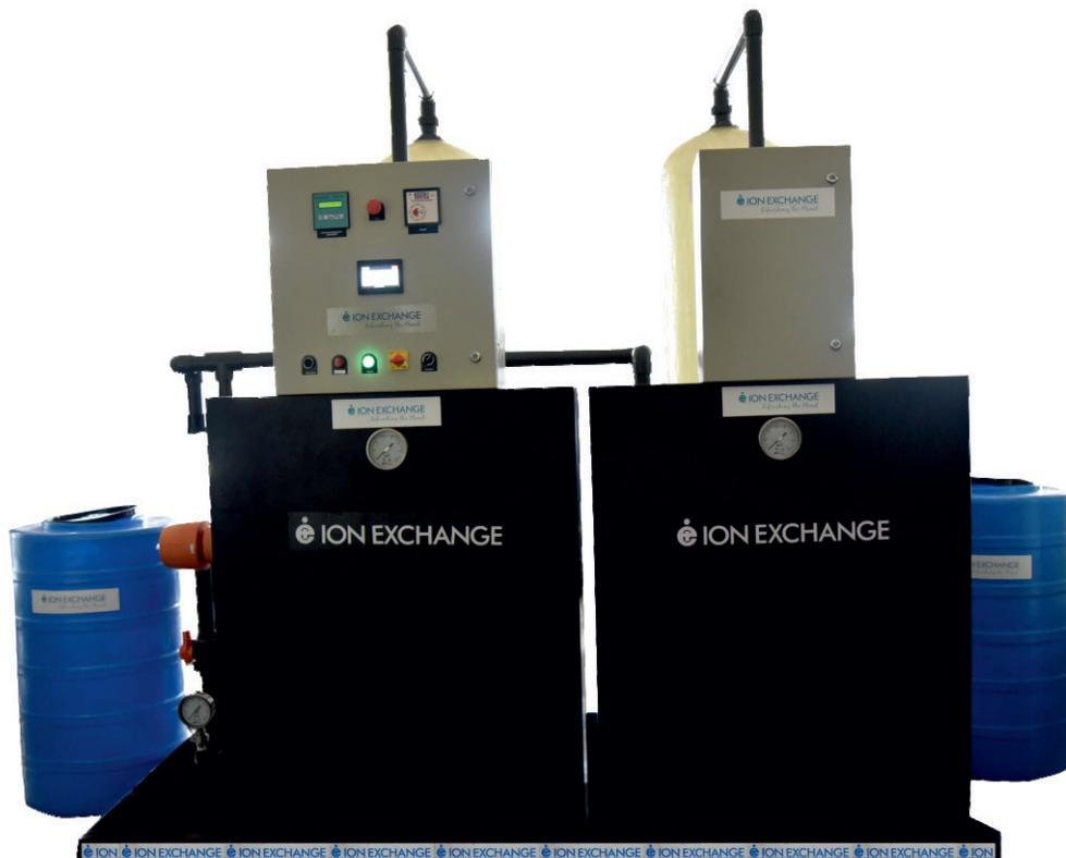
Indion 新世代 (NG) エレガントは、ボイラー、製薬プロセス、電子プロセスに必要な高純度水を生成することができます。Indion NG エレガントは、個別のカチオンとアニオンユニットを搭載したスキッドマウント型で、イオン交換技術のカウンターカレントフローを採用しています。
