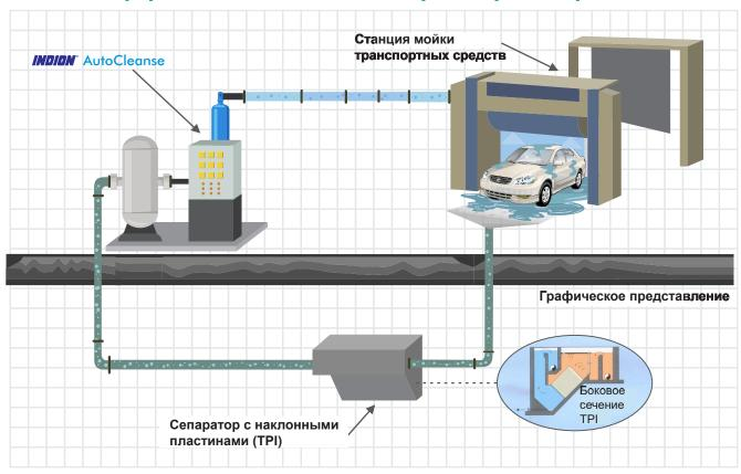
INDION AutoCleanse — современная система для очистки и переработки сточных вод после мойки транспортных средств. Система позволяет экономить 80% затрат на воду за счет сохранения больших объемов пресной воды. Система также соответствует строгим нормам по выбросам в окружающую среду.
