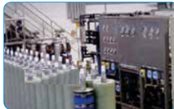
INDION® Sistema de osmose inversa (RO) de estrutura de placas (DT/ PF)*
