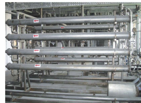
Unidad de ultra purificación de concentración de gelatina en la industria alimentaria y de bebidas
