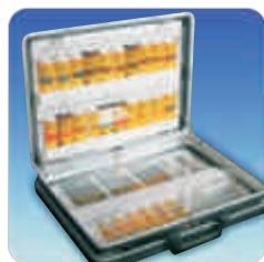
Especialmente diseñados para el análisis in situ de agua de reposición, agua de calderas y agua de refrigeración, sin necesidad de un químico cualificado.
