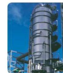
I nostri neutralizzatori del punto di rugiada aiutano a proteggere il sistema superiore della colonna di frazionamento dalla corrosione acquosa mantenendo un profilo di pH uniforme, dalla posizione del punto di rugiada alla sezione superiore dell'acqua iniziale.
