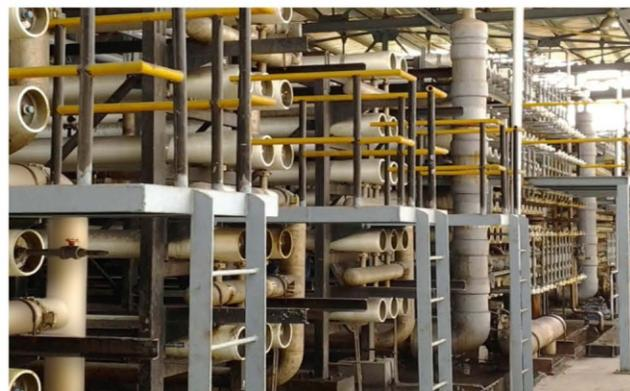
火力発電所における海水逆浸透 (淡水化)
