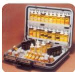
Spécialement conçu pour l'analyse sur place de l'eau d'appoint, de l'eau de chaudière et de l'eau de refroidissement, sans l'intervention d'un chimiste qualifié.
