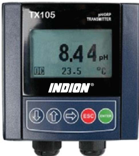
إن Indion TX105 عبارة عن جهاز صناعي معزول بقدرة 4-20 مللي أمبير لقراءة مستشعرات الرقم الهيدروجيني أو ORP. يعمل على تشغيل الوحدة بسهولة باستخدام حلقة إمداد الطاقة المتوفرة بسلكين. مثالي للتوصيل بوحدة التحكم المنطقية القابلة للبرمجة (PLC) لأنظمة التحكم المتقدمة. لديه العديد من خيارات التركيب، بما في ذلك التثبيت على الحائط واللوحة. نظراً لشاشة LCD المزدوجة، فإن مراقبة قيمة القياس ودرجة الحرارة أمر بسيط.
