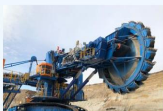
Угольный ковшевый экскаватор
