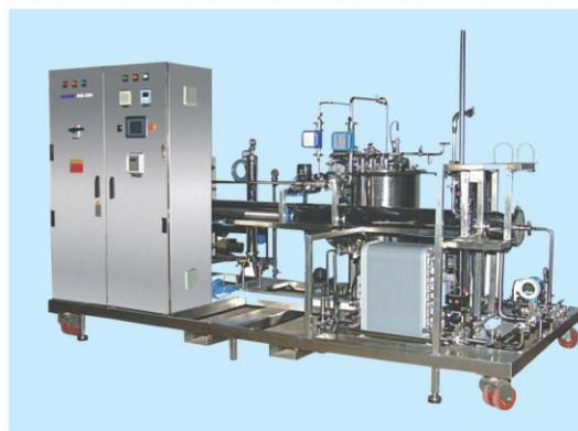
用于制药和电子工业的反渗透 (RO) 电去离子 (EDI) 设备
